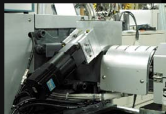
●螺杆松退——异常压力(左上图表圆圈内)将塑胶颗粒推挤到料管壁面，颗粒呈现如固定螺帽的状态，螺杆像螺丝般旋转后退。
