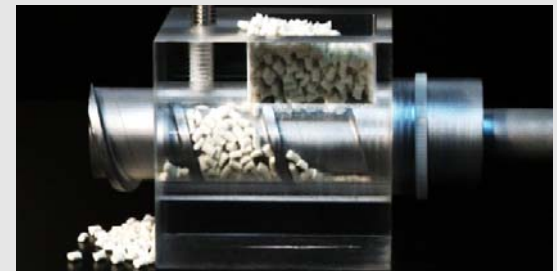
●螺杆松退——异常压力(左上图表圆圈内)将塑胶颗粒推挤到料管壁面，颗粒呈现如固定螺帽的状态，螺杆像螺丝般旋转后退。
