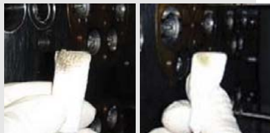
●一般的成形(左边), 1天后PL面上就会附着污垢。使用SL(右边), 16天后仅附着微量污垢。
