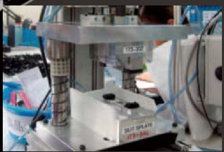
●装置轴承的冲压模座与空压冲床。
