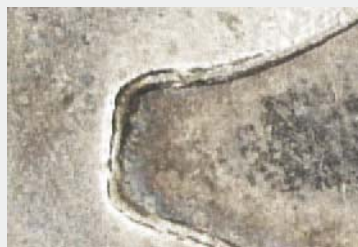
■キャビティの腐食
