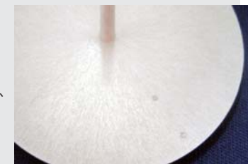
●16LSによる成形。未溶融が解消されウエルドが消えた。
