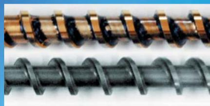
以往型镀膜螺杆(上面)与SPIRAL LOGIC的T-Rex螺杆在同一使用条件下的比较。不产生滞留层的T-Rex螺杆，塑料不会碳化，所以不会导致黑点。
