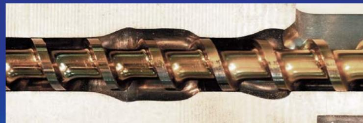
塞满坚硬塑料而产生的压力(摩擦力)非常大。使用如上图已进行磨损的料管，尽管提高保养频率，亦无法实施正常的精密稳定成形，为问题症结。
