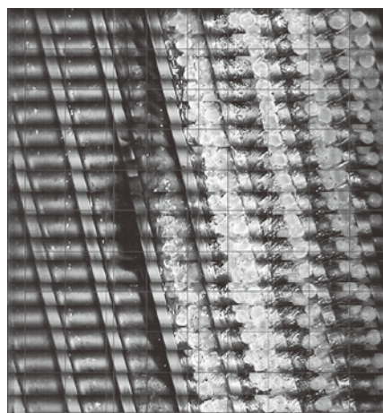
写真1 可視化バレルによる透明ペレットに一粒だけ黒いペレットを混入した状態の分解写真を合成
