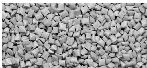
写真5 粉碎材(上)とRaptor22による再生ペレット(下)
