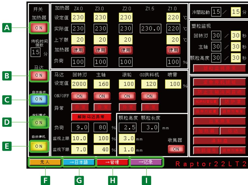
控制盘采用触控式萤幕。若显示项目消失时，碰触萤幕就会显示现况。运转(再生量产)及清料时，使用上图所示的运转画面。
