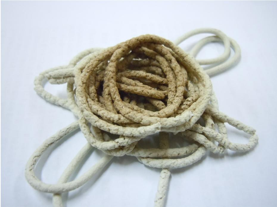
分解した材料は上の写真のように表面が荒れて縄のようになり、更に進行すると下の写真のように細切れの状態で吐出されます。
