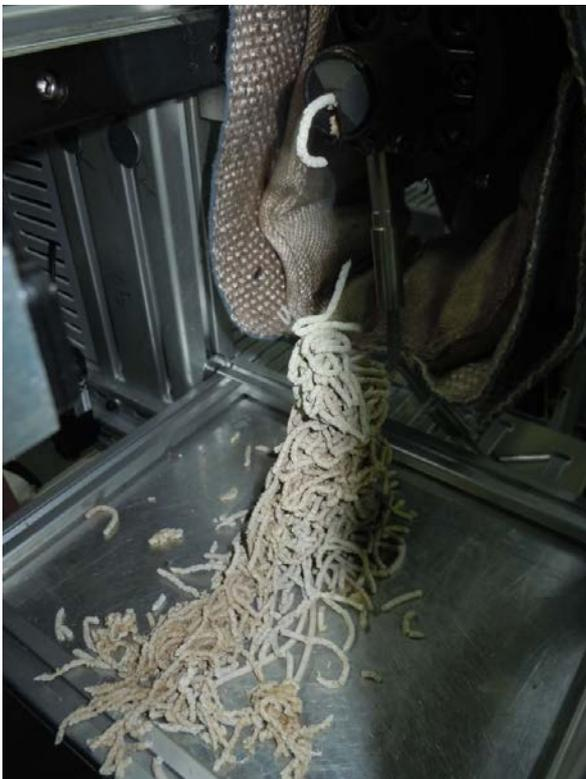
更に滞留が5分を超えると材料は粉を練り固めたような状態になり、粘度が急激に上昇してRaptor22の主軸負荷異常が発生し、吐出出来なくなります。
